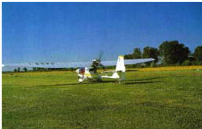
Caratteristica del Piuma Evoluzione è la nuova fusoliera più lunga e con una migliore profilatura aerodinamica
