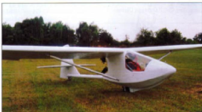
trasporto all'interno di un apposito rimorchio al traino di un'autovettura, è rapidamente smontabile e l'operazione di riassettaggio richiede una trentina di minuti.
